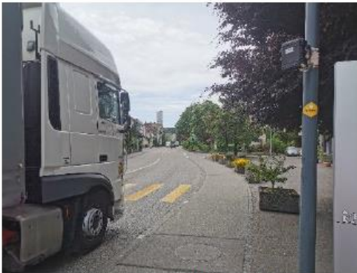
Abbildung 1: Zählgerät an Kandelaber montiert
